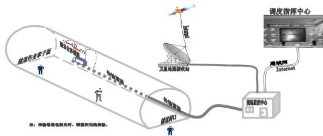
图 9.10-1 隧道变形监测系统应用示意图
