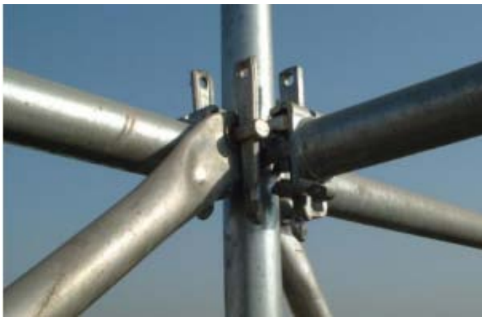
图 4.9 插接式脚手架节点
